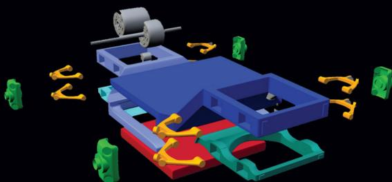
Erweiterbares Chassis mit verschiedenen E-Motoren Optionen & Akku Konfigurationen.
